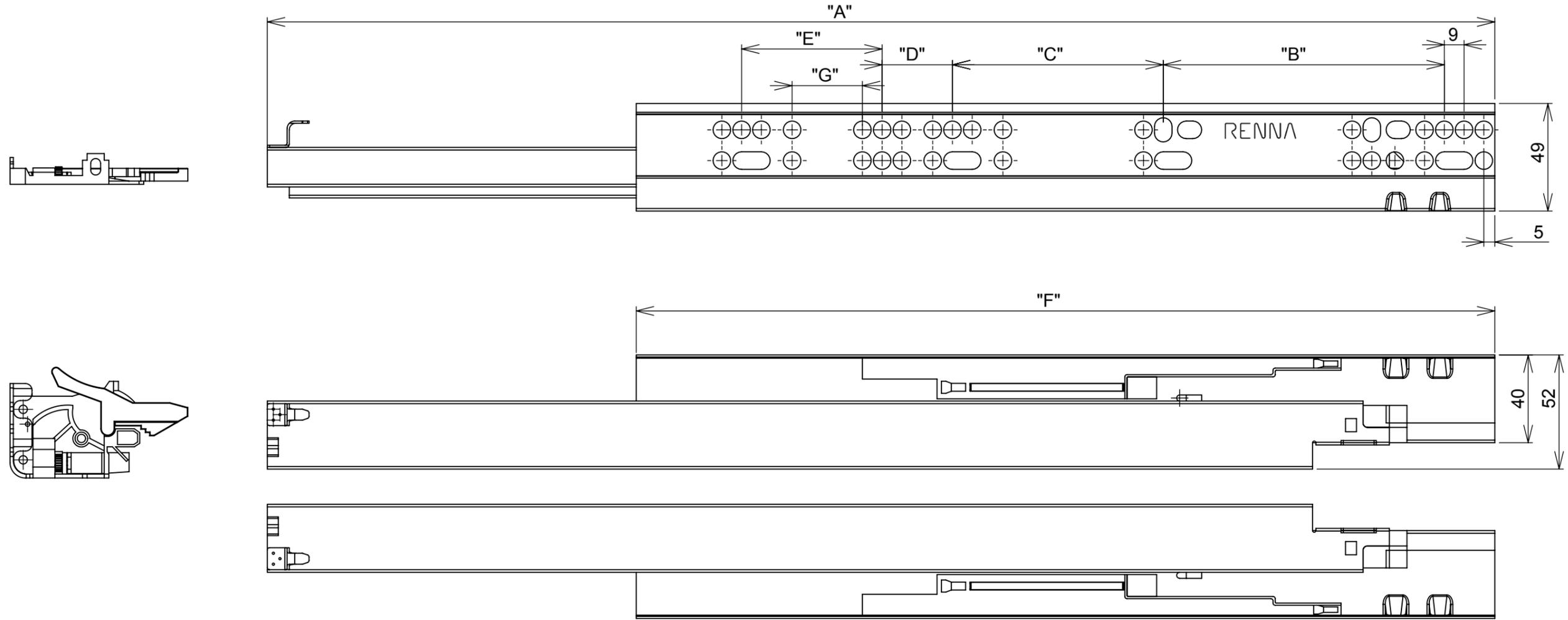
PAR DE TRILHO INVISÍVEL (FIXAÇÃO POR BAIXO DA GAVETA), PARA MÓVEIS RESIDENCIAIS E OU COMERCIAIS, EM AÇO ZINCADO, COM AMORTECIMENTO. ACOMPANHA GATILHO PARA AJUSTE/INSTALAÇÃO.
